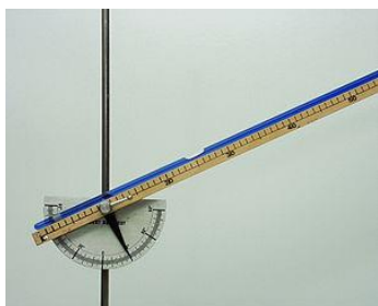
1.2.ábra. Szögmérővel ellátott Mikola-cső Bunsen-állványba fogva
